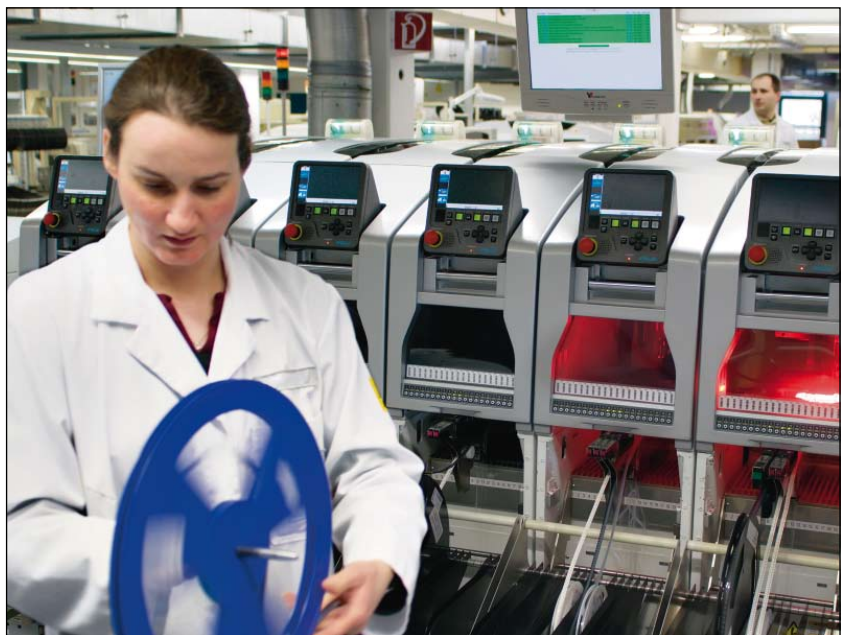
Bild 1: Für Multilayer-Platinen Boards sind hocheffiziente und präzise Fertigungsanlagen und ein großes Know-how des Fertigers notwendig, damit BGAs mit 1500 Anschlüssen oder kleinste Bauformen wie 0402 und 01005 fehlerfrei verarbeitet werden. (alle Bilder: Ortgies)
