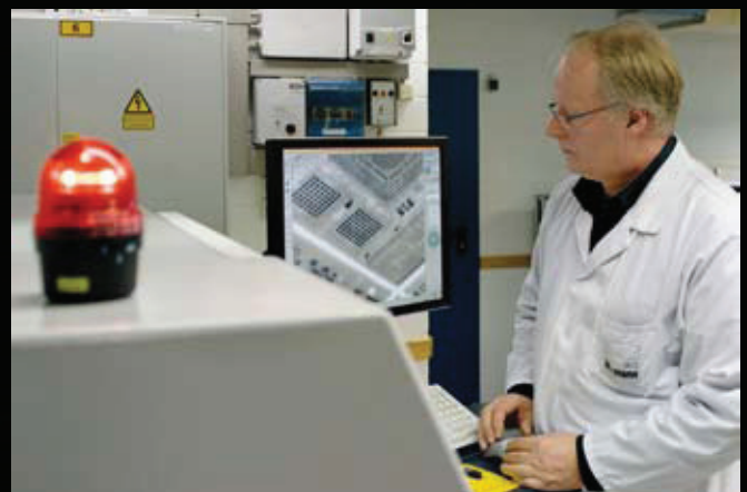
Für die Kontrolle von BGA-Lötungen kommt moderne Röntgentechnik zum Einsatz, da Sichtkontrollen hier nicht möglich sind. Auf diese Weise lassen sich versteckte Voids bei den Lötverbindungen schnell aufspüren.
